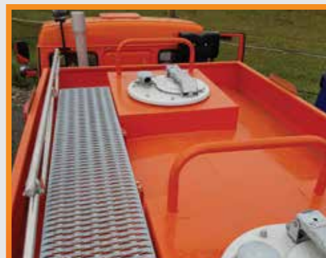
Площадка обслуживания и заливные горловины
