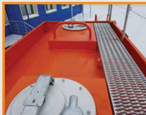
Площадка обслуживания и заливные горловины
