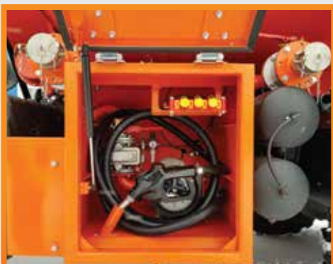
Узел выдачи топлива
