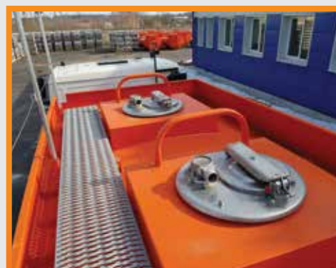
Площадка обслуживания и заливные горловины
