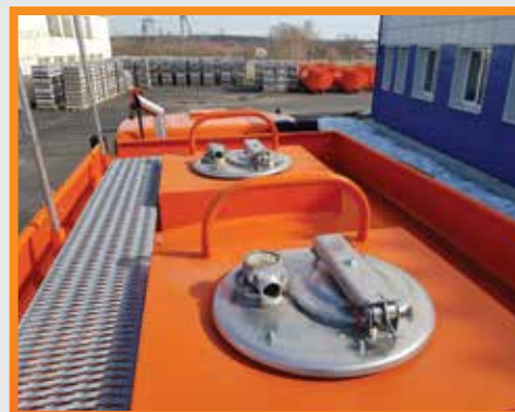
Площадка обслуживания и заливные горловины
