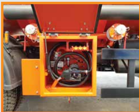
Узел выдачи топлива
