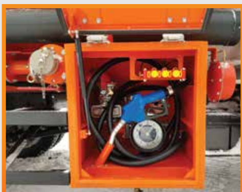
Узел выдачи топлива
