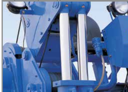
Запатентованная технология с двумя гидроцилиндрами держика
